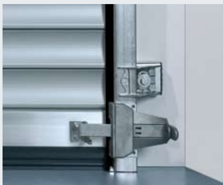
Cerrojo Montado en el carril-guía, a elección, a derecha o izquierda. El bloqueo se puede asegurar con un candado. No para puertas enrollables exteriores.
