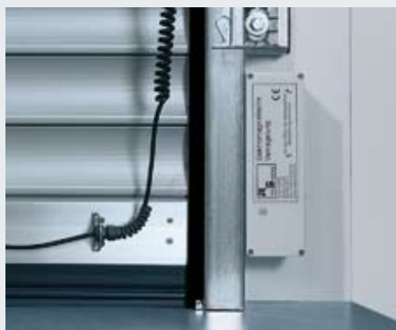
Bloqueo electromagnético Accionamiento mediante contactor de llave de serie. Bloqueo automático en la posición "Puerta cerrada", posible conectar al cuadro de maniobra central.
