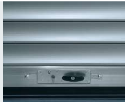
Perfil inferior cerrable desde el exterior Con bombín de semicilindro bloqueable desde el interior sin llave. Accionamiento desde el exterior mediante tirador de concha avellanado, desde el interior mediante pomo en cruz. Para todos los anchos de puerta.
