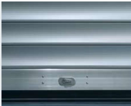
Perfil inferior cerrable desde el interior Con bombín de semicilindro, accionamiento directo mediante llave. Para anchos de puerta hasta 4000 mm.
