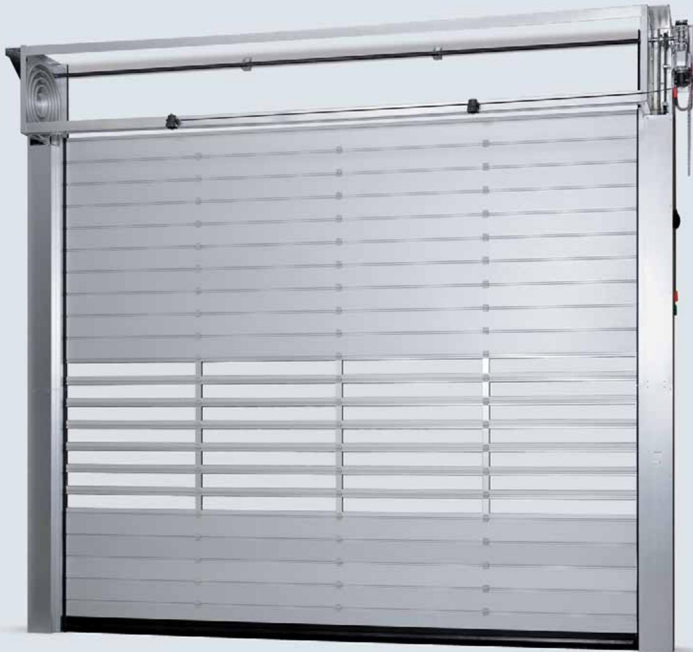
La puerta espiral HS 7030 PU se caracteriza por su elegante acabado Micrograin, los paneles sándwich de acero galvanizado al fuego, su alto aislamiento térmico, su elevada velocidad de apertura, la técnica de enrollamiento libre de contacto y la rejilla fotoeléctrica de seguridad de serie.
