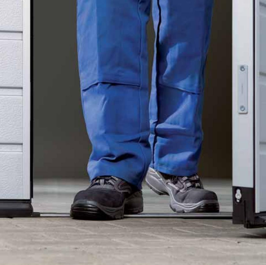
**Puerta peatonal incorporada sin umbral elevado, con un umbral de acero inoxidable de sólo 10 mm de altura en el centro y 5 mm en los bordes. En las puertas desde 5510 mm de ancho el umbral tiene aprox. 13 mm de altura.**
