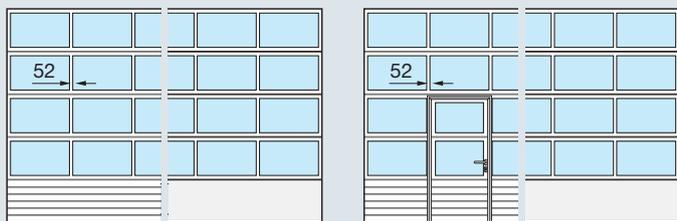
En puertas hasta 5500 mm de ancho, de serie con perfil de modulación de 52 mm.
