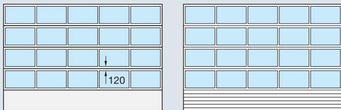
En los acabados Micrograin y con gofrado Stucco, la puerta se suministra de serie con un zócalo de 750 mm de alto y opcionalmente con: 500 mm, 1000 mm y 1500 mm
